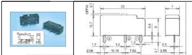
NRP連續印刷電路板用電路保護器
