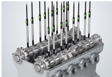
檢查凸輪軸的擺幅
