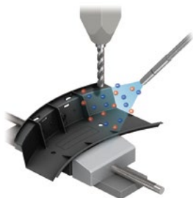
儀錶板部件加工時的靜電消除
