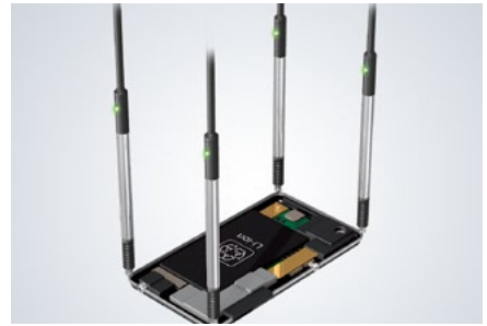
檢查智慧型手機外殼的平整度
