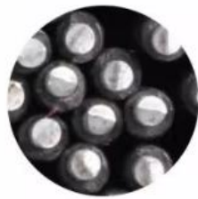
铁丝直径1.2毫米
