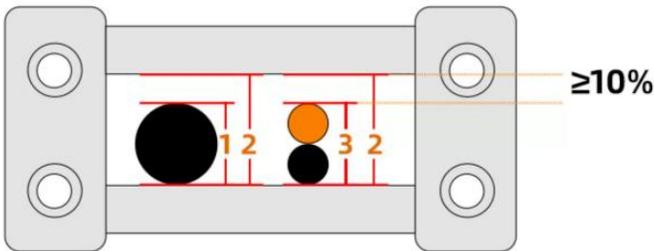
$$(\text{拖链内高}2) \geq (\text{电缆直径}1) \times 10\%$$
