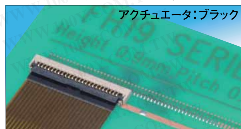
FH19SCシリーズ／適合FPC・FFC厚0.3±0.03mm
