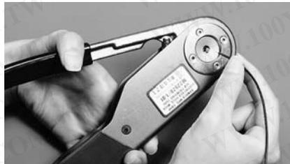
コンタクト圧着部孔に電線を完全に奥まで挿入します。
