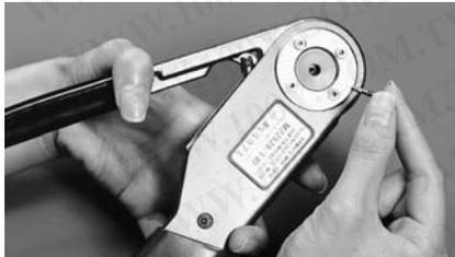
圧着するコンタクトを工具の圧着部孔に入れます。
