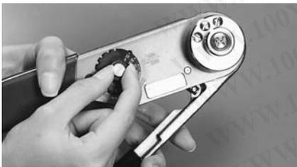
工具にロケータを取付け後、圧着するコンタクトと電線サイズにより位置決め番号をセットします。
