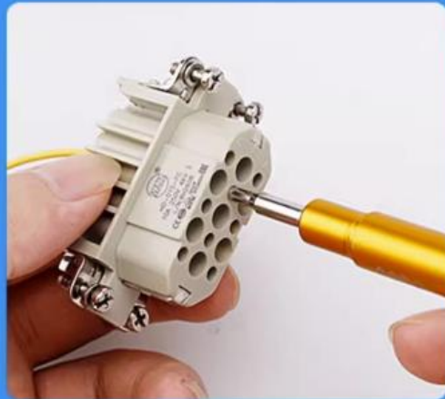
2、将退针器插入连接器直至到达底部
