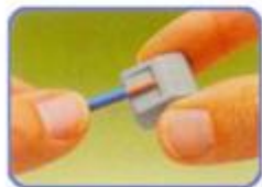
按标定长度剥去导线外皮9-10mm 用姆指将橘色压杆往上移动 开启弹簧 按下橙色操作手柄 导线即可接好
