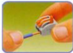
按标定长度剥去导线外皮9-10mm 用姆指将橘色压杆往上移动 开启弹簧 按下橙色操作手柄 导线即可接好
