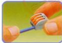
按标定长度剥去导线外皮9-10mm 用姆指将橘色压杆往上移动 开启弹簧 按下橙色操作手柄 导线即可接好
