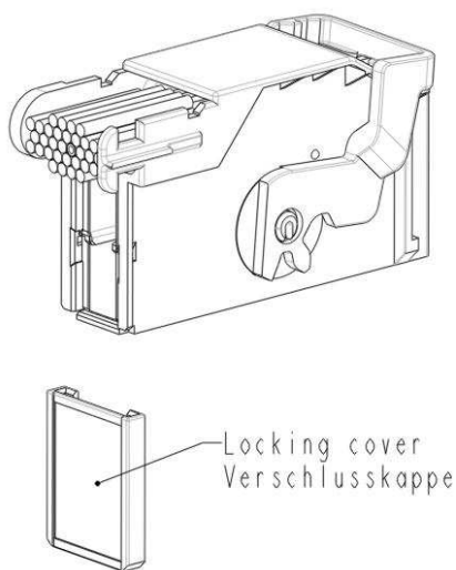
fig. 6: 32 posn. Connector with locking cover Abb.6: 32 pol. Steckverbinder mit Verschlusskappe
