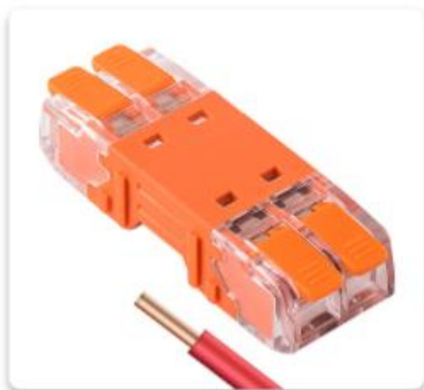
1.剥去导线外皮11mm
