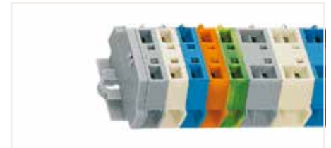
端子排, 带有固定耳, 适用于螺丝或相似安装类型, 3.2 mm 固定孔直径(带适于DIN 35型导轨的209-123固定销钉)
