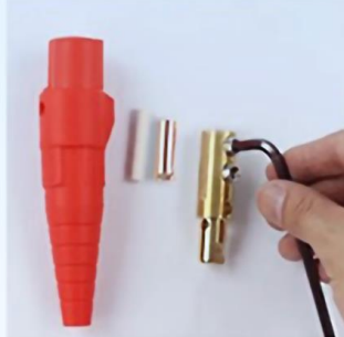
2. 使用六角扳手松开两枚螺丝
