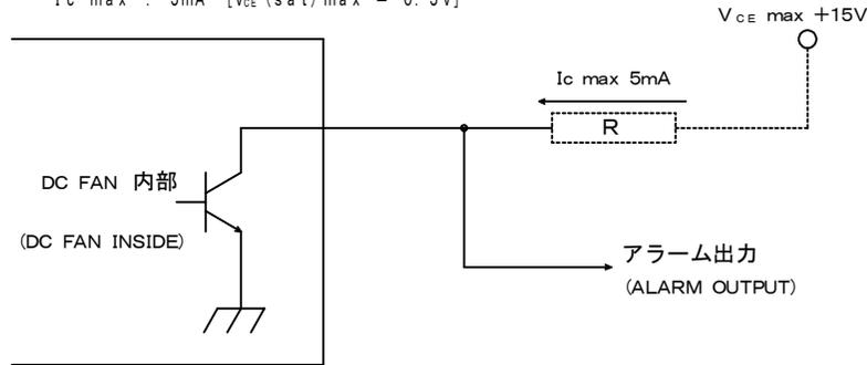
図1. アラーム信号回路 (ALARM SIGNAL CIRCUIT)
