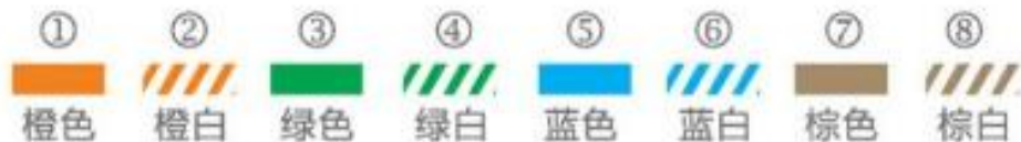
常见网线颜色T568标准线序示意图
