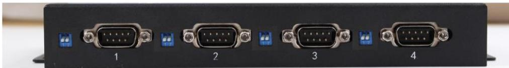
图 12 拨码开关 RS232 状态
