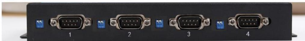
图 13 拨码开关 RS485 状态
