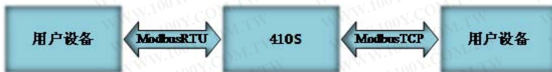
图 7 Modbus RTU 转 ModbusTCP 结构图
