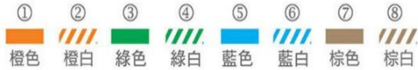
常見網線顏色T568標準線序示意圖
