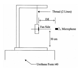
1 METER FROM MICROPHONE TO FAN INTAKE
