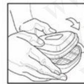
**2.** 将滤棉盖扣向滤盒并卡定。如装配正确，滤棉将完全盖住滤盒表面。
