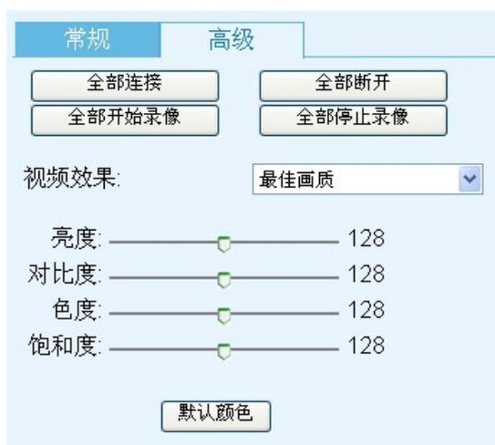
全部连接：用于连接摄像机增加的全部外部设备。
