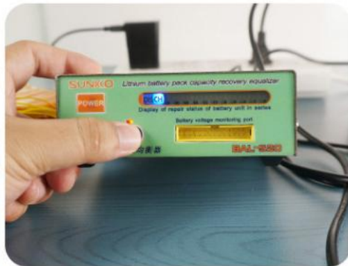
6. 按下CH/DIS切换到放电模式 (充电模式中, CH/DIS工作灯亮起, 电池充满电后指示板会亮灯)
