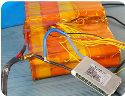
1. 把电池组保护板短路 (充电均衡过程需断开保护板)
