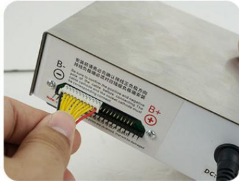
2. 接入电池组排线 (负极接入仪器B- / 反接会对仪器造成损坏, 请谨慎操作)
