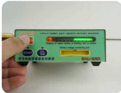
4. DIS放电模式开始工作 (平衡仪开机默认是电池放电模式)
