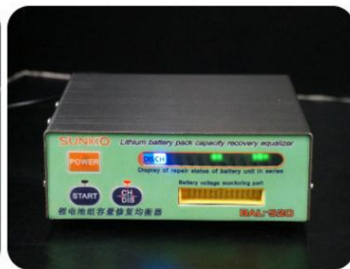
CH灯亮起, 开启充电模式 (按下CH/DIS按键, 切换充电模式 充电结束后, 指示灯亮起)
