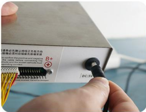
3. 接入均衡器电源 (采用5V适配器)
