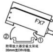
附带放大器安装支架或35mm宽DIN导轨
