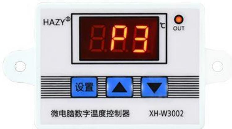
同样方式进入内部菜单，通过上下按键切换成 P3，再次按一下设置键，通过上下按键设置需要的延时时间，单位是分钟。(注：延时启动一般用于压缩机制冷，如果用于冰箱冰柜，此值需要设置一下，根据压缩机回压大小，一般设定值为 3-6 分钟，如果您不是用于控制或不需要延时功能，直接跳过。)
