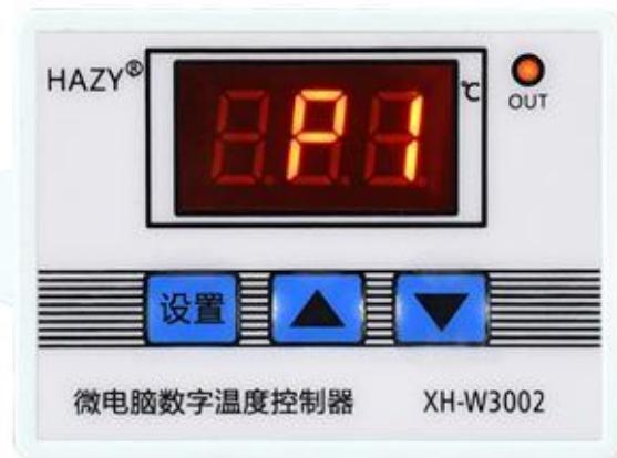
按一下设置键，进入内部菜单，显示为 P0，通过上下键切换成 P1，再次按一下设置键，通过上下按键设置需要的停止温度。
