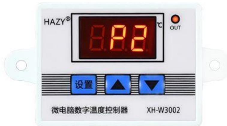
同样方式进入内部菜单，通过上下按键切换成 P2，再次按一下设置键，通过上下按键设置需要的校准温度。(注：设置中，如果检测温度值比实际温度值大 0.5℃，那么需要设置的校准温度就是 -0.5℃. 如果检测值比实际温度值小 1℃，需要设定的校准温度就是 1℃。检测温度 + 校正温度 = 实际温度。)
