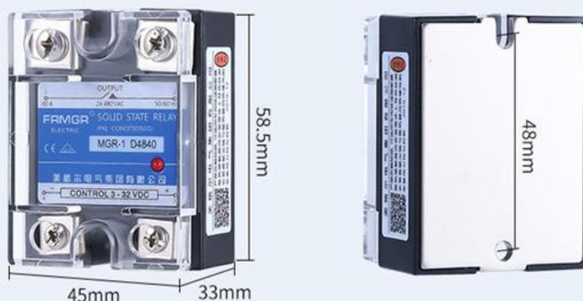
温馨提示：固态继电器发热较大，在使用负载电流高于10A时，必须使用散热器，需在固态继电器底板与散热器之间涂上导热硅脂（60A以上加风扇较强）
