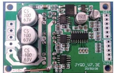
JY01所组成的中功率直流无刷有霍尔与无霍尔控制板，6只TO-220封装的大功率场效应管装在PCB背面，此控制板VCC电压在12V--48V的范围内，最大工作电流达20A（要加适当的散热措施），此类电路已经成功应用在诸如直流无刷风机电机、直流无刷水泵电机、滑板车电机、手持设备等
