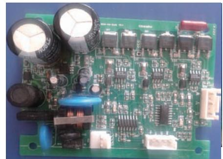
如上图所示为高压直流无刷无霍尔电机驱动器电路，220VAC直接供电经整流滤波后产生310V直流电，再由JY01控制三路输出驱动高压直流无刷电机，按原理图参数最大可驱动100W以内的电机，此电路已经成功应用在空调内机，高效节能排气扇，无叶扇，风机等高压直流无刷无霍尔电机中
