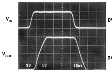
$A_V = +10$ ,  $R_F = 750\Omega$ ,  $R_G = 820\Omega$ ,
