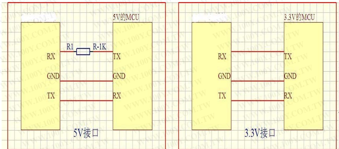
晶片的串口為 3.3V 的 TTL 電平，所以默認的介面的電平為 3.3V。如果系統是 5V。那麼建議在串口的對接介面串聯一個 1K 的電阻。這樣足以滿足一般的要求，如果應用于強電磁干擾的場合，請參考“注意事項”的說明。晶片在 5V 和 3.3V 的系統中均正常的測試過，一切正常。均在採用的是直連的方式，並沒有串 1K 的電阻
