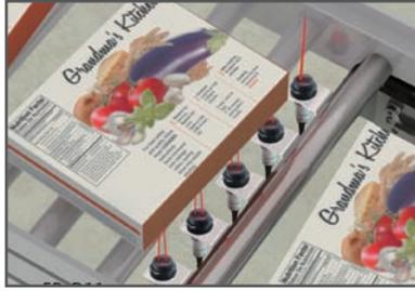
多个传感器并排安装检测生产线上尺寸不一的包装
