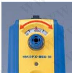
以焊咀溫度計測量焊咀溫度的同時轉動旋鈕直至焊咀溫度計顯示 350°C, 再按補正按鈕返回正常模式。
