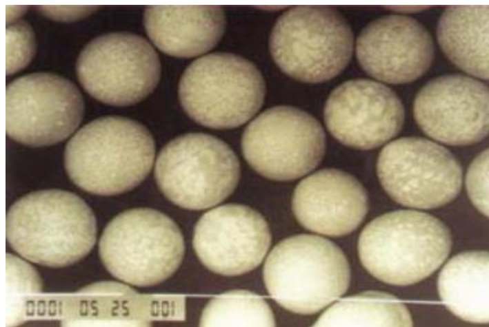
Sparkle Paste OZ powder Sparkle Paste OZ powder 粉末 “氧化物零” OZ 均勻球體 “氧化物零” OZ 均一的球狀 照片中的一條白線是 100 um 照片中白線代表 100 um
