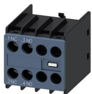
auxiliary switch, on the front, 1 NO + 1 NC, .1/.2, .3/.4, --/--, --/--, current path: 1 NC, 1 NO, --, --, screw terminal, for contactors 3RT2 and contactor relays 3RH2
