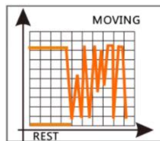
受震动或摇晃时开关波形 开关在震动时为ON/OFF不停转换
