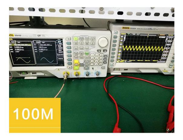
左边由信号发生器给发射模块输入100MHz,2Vpp的正弦波信号 经过两个模块的电光-光电转换后得到右边示波器效果图,频率 为96.15MHz
