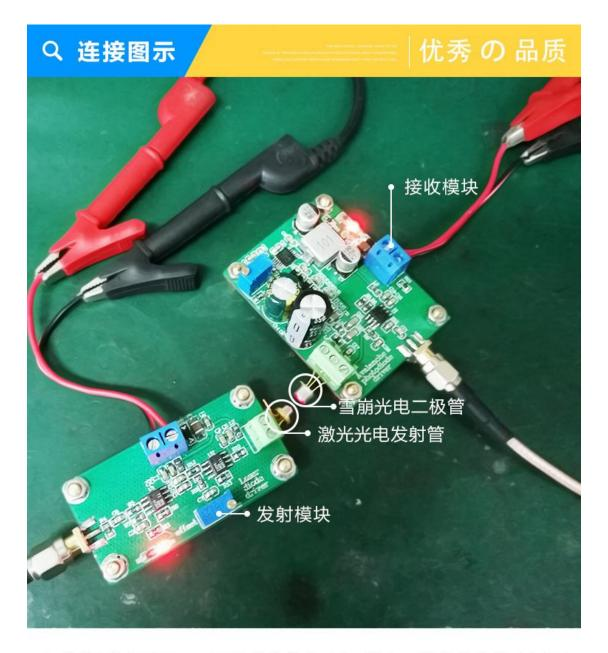
如连接测试图所示,两个模块均为12V供电,发射模块输出端用 激光光电发射管将光信号发射到接收模块输入端连接的雪崩光电 二极管上,由于所选用的激光发射管功率较小,光信号不是很集 中,所以测试距离要比较近才能得到较好的效果。当然也可以光 纤进行传输,这样效果也比较理想。
