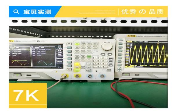
左边由信号发生器给发射模块输入7KHz,2Vpp的正弦波信号经过两个模块的电光-光电转换后得到右边示波器效果图,频率为7.143KHz
