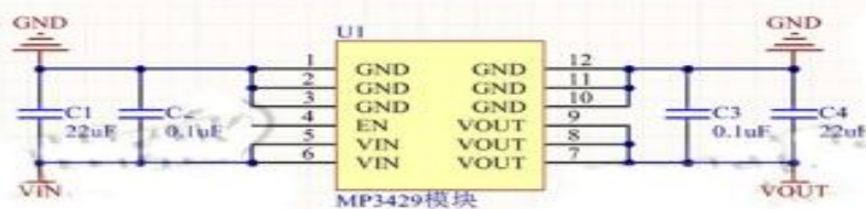
典型应用图(输入电容可不焊接)
