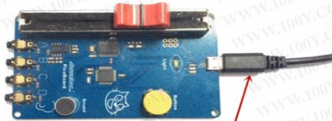
使用 Micro USB 线连接 Picoboard 和 PC
