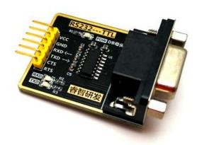
功能简介:RS232转TTL,TTL转RS232,升级小板
