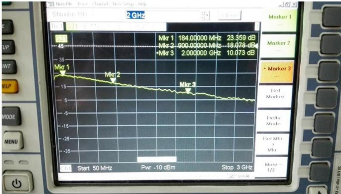
低噪声放大器 0.05 ---4GHz NF:0.6dB LNA 射频放大器测试数据
