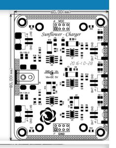
SunFlower Li Battery Charging Board是一块以TP4056电源芯片为主芯片的锂电池充电板,输入电压为DC 5V,充电电压为DC 4.2V,一块电路板最多支持5路锂电池同时充电,每路输出都配有独立的自恢复保险丝,以防止电路出现故障时烧毁其他电路,并且支持多块电路板级联充电,即共用一个输入,输出为5\*n路。当电路无电池在充电时,绿色LED被点亮,并伴随着红色LED的微微闪烁;当电池在充电状态下,只有红色LED被点亮;当电池达到充满状态,只有绿色LED被点亮。
