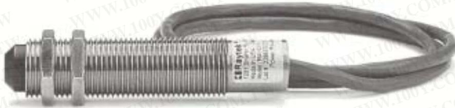
CI 系列是美國 Raytek 公司所推出高品質，低價位的非接觸式紅外線測溫器。CI 能輸出 J 和 K 熱電偶信號，並具有極低的輸出阻抗，可以直接取代熱電偶偵測頭，而不需更換原有的顯示或控制器。因為不需接觸到物體，所以 CI 永不磨損，且無須定期更換偵測頭，CI 可以很輕易的被安裝在一定的距離內，來偵測發熱且移動的物體。CI 能提供比熱電偶更好的準確度、重覆性和更快速的反應時間。
