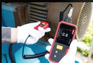
電機振動檢測
