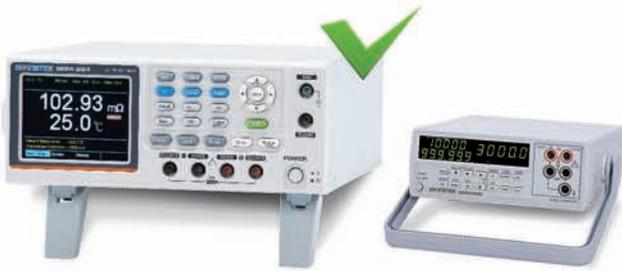
GOM-804/805無論是在基本的功能、規格上，是以可完全取代現有機型~GOM-802為出發點；因此，所有GOM-802能提供的，都可以在GOM-804/805上找到完全對應的功能，包括可涵蓋既有範圍之電阻量測、1A測試電流(最大)、四線式量測方式、以溫度測棒(選購配件PT-100)進行溫度量測或溫度補償量測...等；甚至在程控所需的指令，也能全數兼容。簡言之，全新的GOM-804/805，除了能提供最佳的顯示介面、更快速的量測速度(可達每秒60個讀值)，甚至搭配有標準的通訊介面(RS-232C/USB device)，協助使用者精準、快速地完成量測任務；同時，在機型替換上也不會造成任何的困擾和麻煩。
