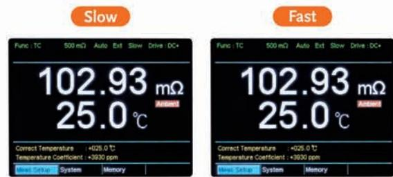
GOM-804/805提供了可供選擇的2段量測速度-快速~可達每秒60個讀值/慢速~每秒10個讀值。不同於以往，使用者必須在速度和顯示解析度間進行取舍，在GOM-804/805上，無論選擇的速度為何，都會維持最高的顯示位數；即讀值解析度不會因為速度模式的改變，而有位數減少的情況。
