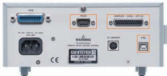
此外，在連接外部控制方面，GOM-804/805提供一個D-sub 25-pin複合式的介面，可依功能的選擇，執行特定的作業，如Handler或Scan或EXT IO，分別提供連接分選機、外部開關或直接進行外部觸發控制；最後，對於需求透過遠端控制和擷取量測結果，GOM-804/805也提供了多樣的介面選擇，如RS-232C、USB以及GPIB (GOM-804選購/GOM-805標準)介面。
