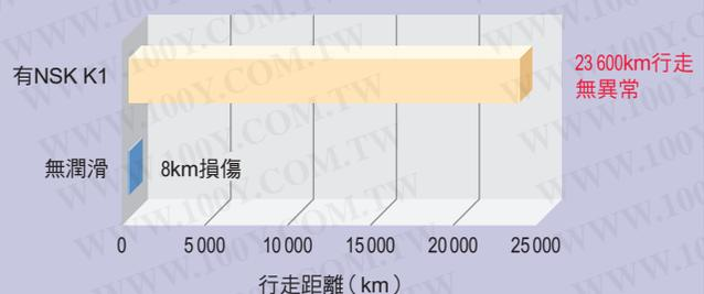
滾珠螺桿：軸徑20mm×導程20mm
