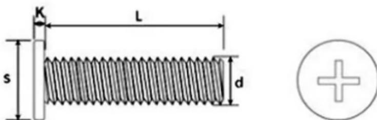
单位：mm 规格由d\*L组成 如：M4\*6(螺纹直径4mm\*长度6mm) 不含头部
