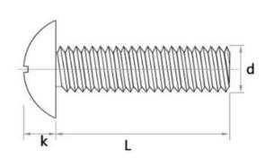
d:代表螺纹直径 L:代表螺纹长度(不含头部)
