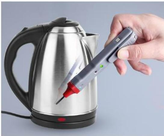
**家用电器接地重要性：**家用电器设备由于绝缘性能不好或使用环境潮湿，会导致其外壳带有一定静电，严重时会发生触电事故，为了避免出现事故可在电器的金属外壳上连接一根电线，将电线的另一端接入大地，一旦电器发生漏电时，接地会把静电带入到大地释放掉
