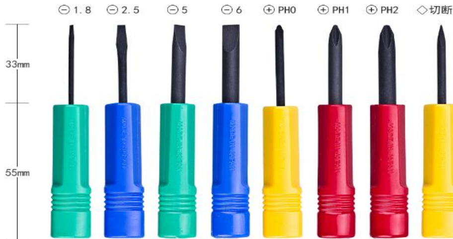
手柄与螺丝刀组合后总体尺寸
