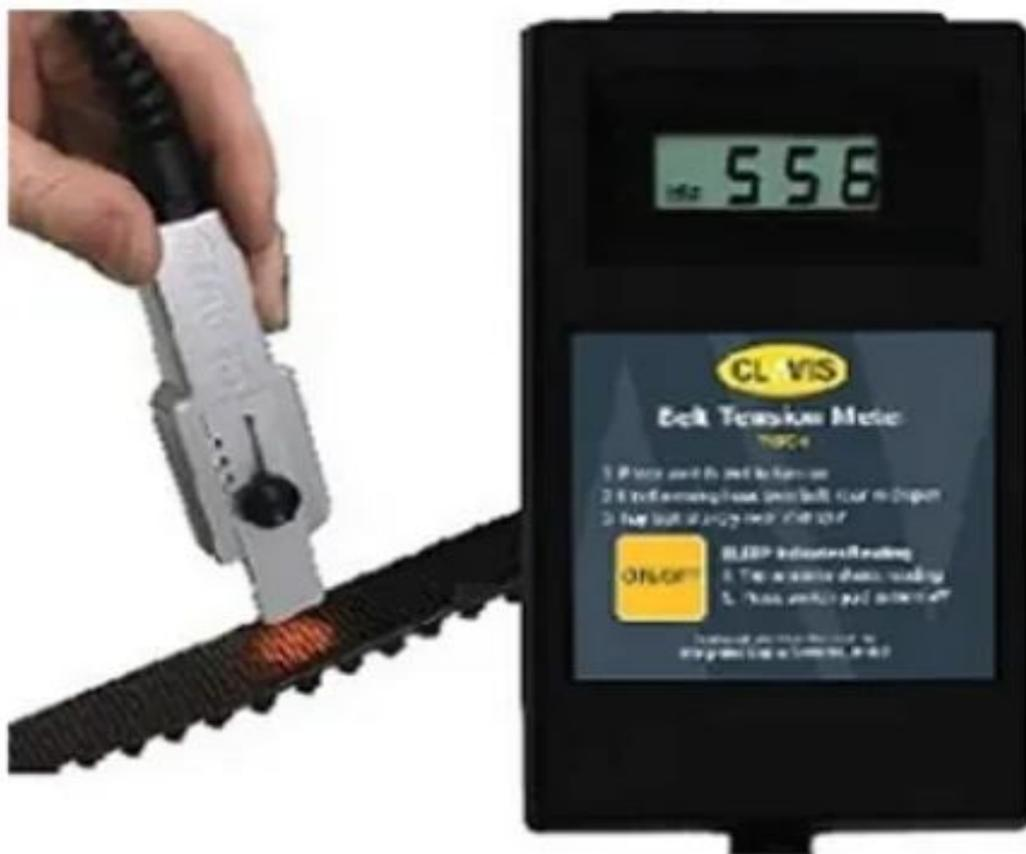
非接觸皮帶張力計是由兩部分組成的檢測系統:以電纜線連接光學感測頭的手持顯示計組成.光學的紅外線偵測皮帶被撥動之振波 Hz 並發送訊號到顯示計. 感測頭用 LED 的橘色光束協助不可見的紅外線瞄準皮帶
