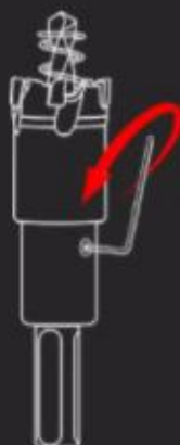
1. 逆时针将螺丝拧出部分
