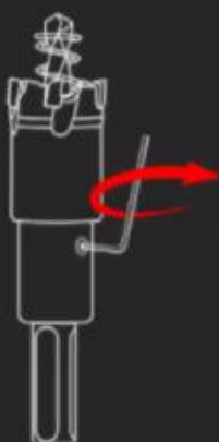
3. 顺时针拧紧螺丝固定钻头
