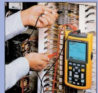
procedente de la tarjeta digital sin tocar un sólo botón. El disparo, la amplitud y la base de tiempos se ajustan automáticamente para proporcionar una visualización estable incluso de una señal de control digital compleja.
